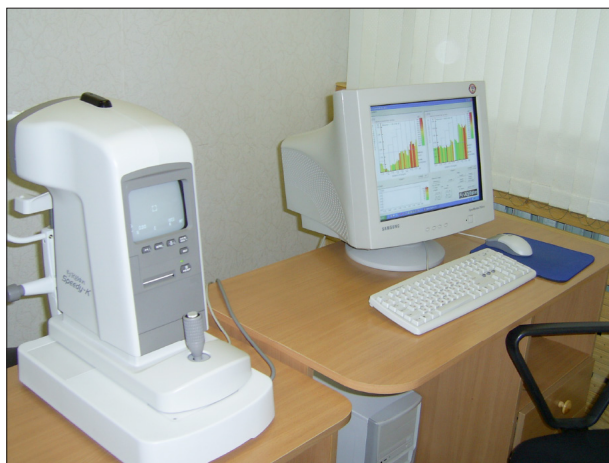
Рис. 1. Аппарат Speedy-K ver. MF-1 для оценки аккомодации
